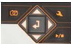
使用开始/停止测量可以启动或停止。任意数量的测量都可以连续记录,而不需要读出之前记录的数据。“手动触发”按钮能够开启使用示波器记录器和 10ms 有效值记录器存储。
