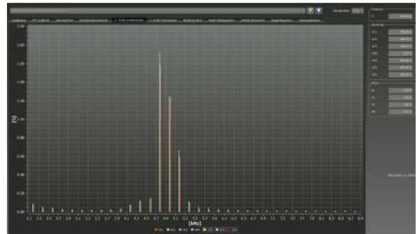
在线谐波 (电压和电流可达 9 kHz)
